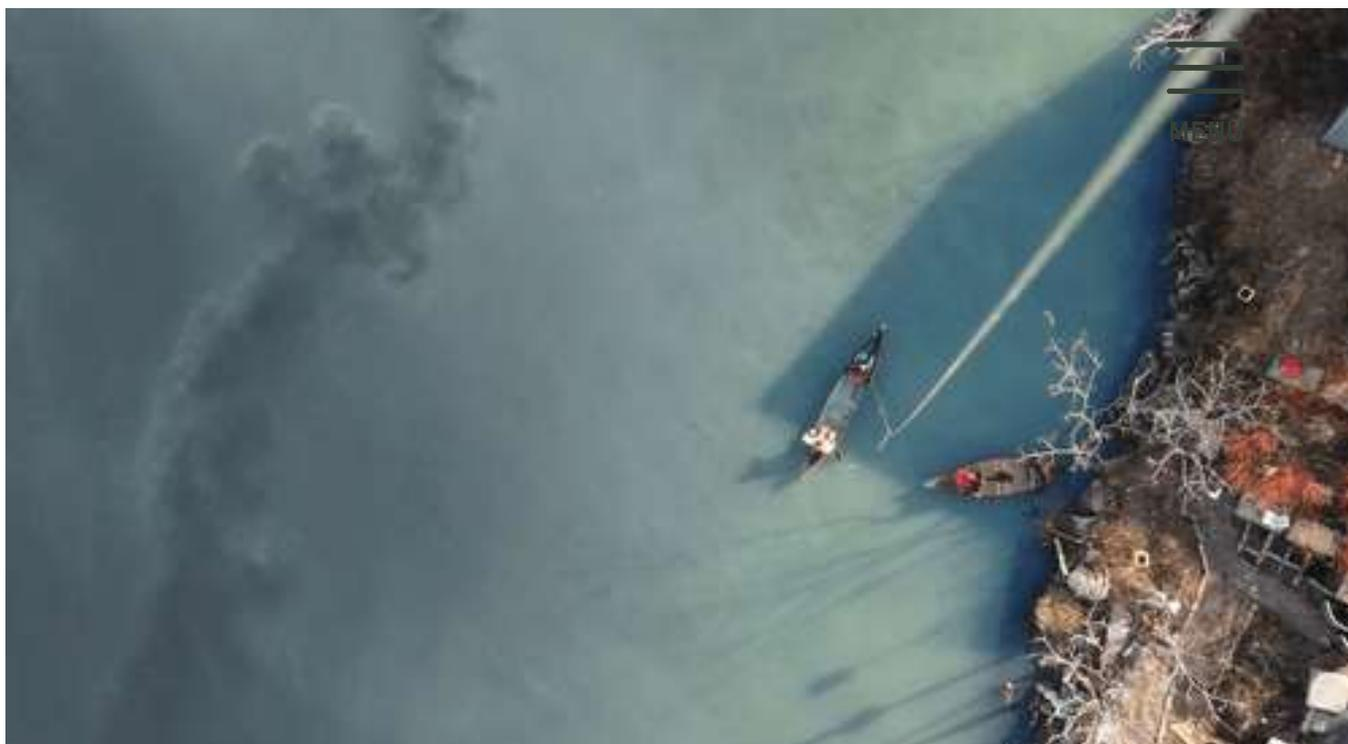
Extrait d'une note de recherche d'Eymund Diegal pour le Public Lab au sujet d'une cartographie des flux d'égouts dans le canal Gowanus, à Brooklyn. On remarque les gens sur les bateaux qui collectent les images et le câble qui les relie physiquement au ballon et à la caméra.
